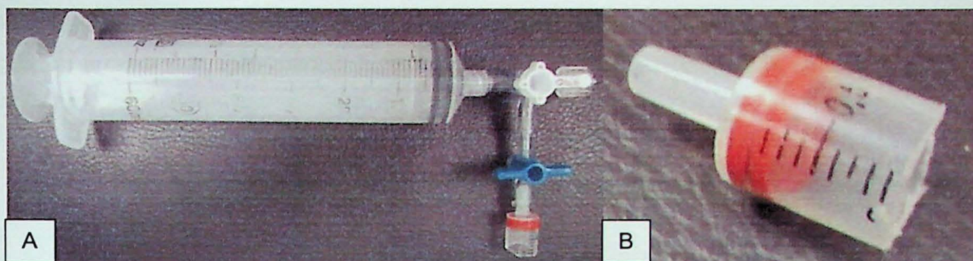
Figura 16 – Sistema para recarga de N_2 para a seringa. A – Sistema completo, com válvula hospitalar de 3 vias (branca) é conectada a outra de 2 vias (azul) e dispositivo de entrada da agulha. B – Detalhe para o dispositivo de entrada de agulha, composto por uma seringa por 5 mL cortada e dois septos.
